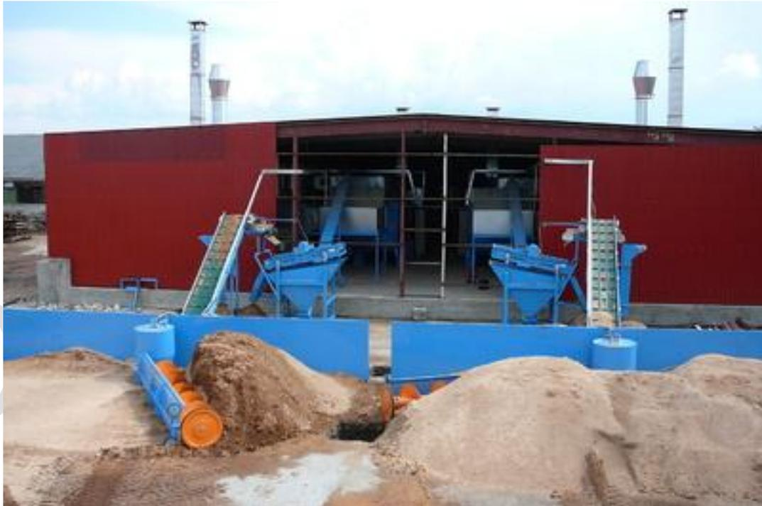
Ilustrační foto využití šnekového dopravníku. Illustration Foto Förderschnecke Verwendung.
