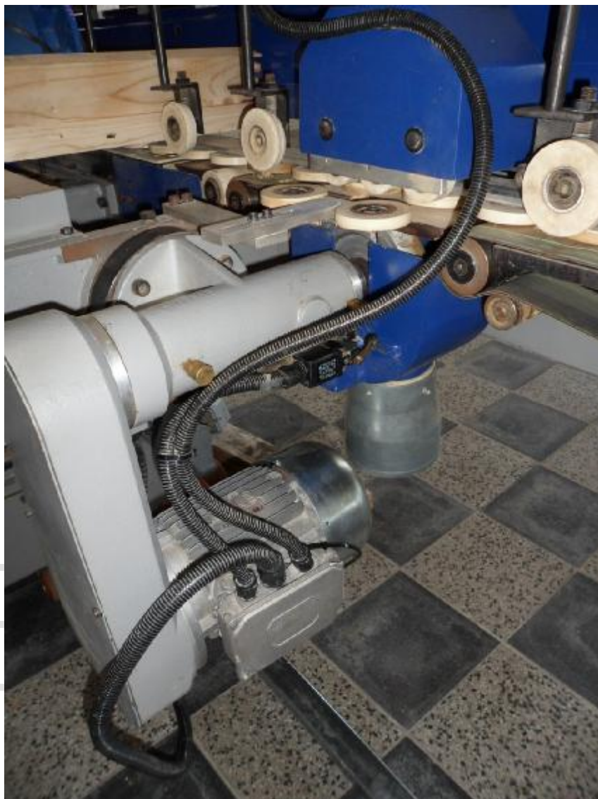
Frézovací agregát/ Fraesaggregat / milling unit / unità di fresatura 2,4 kW/2800 ot/min
