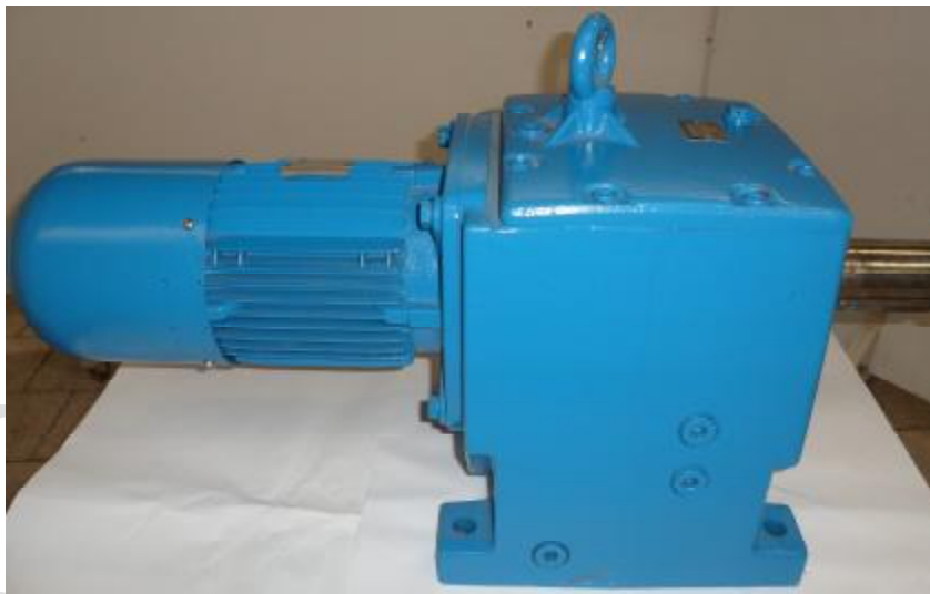
NORD SK 63-100 I/40 BRE 40 EL.Motor 100I/40 BRE 1440 u/min 3 kW
